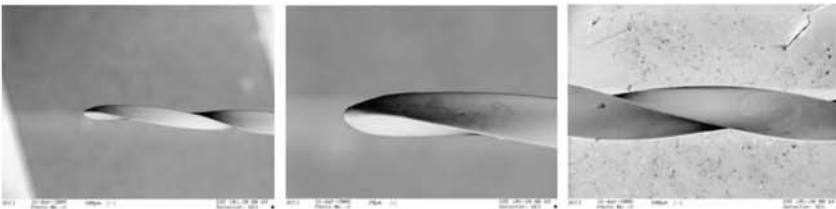
Elektrokimyasal yüzey cilaması öncesinde ve sonrasında eğe yüzeyi
